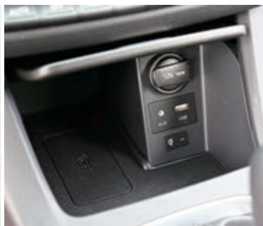
Die Media-Eingänge sowie die Induktiv-Ladestation sind im i30 gut erreichbar
