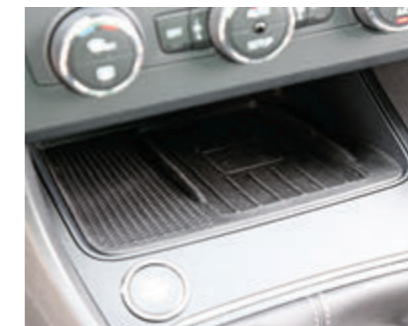
Seit dem Facelift können im Leon compatible Smartphones induktiv geladen werden
