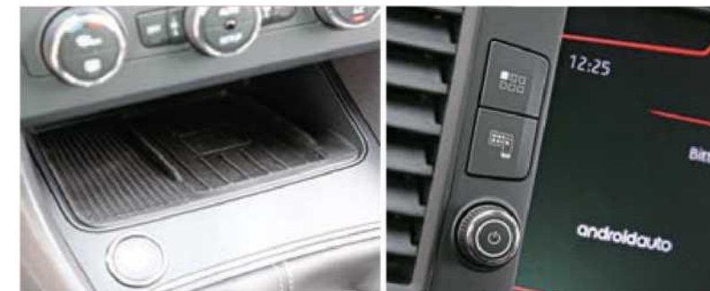
Od faceliftu je možné ve vozech Leon indukčně nabíjet kompatibilní smartphony
