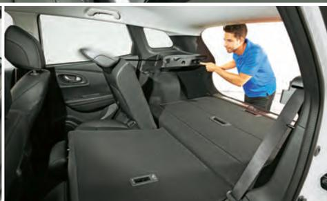
**DIE FERNENTRIEGLUNG** der Rücksitzlehnen per Hebelzug vom Kofferraum aus ist eine praktische Hilfestellung beim Beladen. Obwohl der Kadjar auf der Plattform des Qashqai steht, kann er deutlich sperrigeres Ladegut aufnehmen als der Nissan. Das liegt nicht nur an der etwas längeren, breiteren und höheren Karosserie, sondern vor allem an der größeren Kofferraumöffnung
